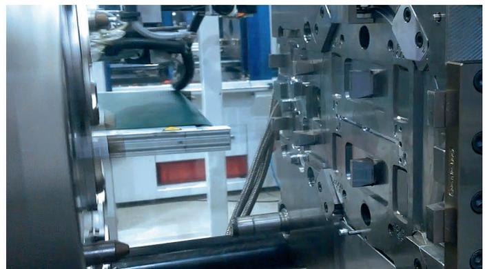
**Bild 4.** Der Drehteller dreht sich um 180°, sodass der frisch gespritzte Lichtleiter aus PC auf der Auswerferseite in Station 2 gelangt (Standbilder aus einem Video). Dort entsteht aus schwarzem PC+ABS die Innenkontur mit Montageelementen (© KH)
